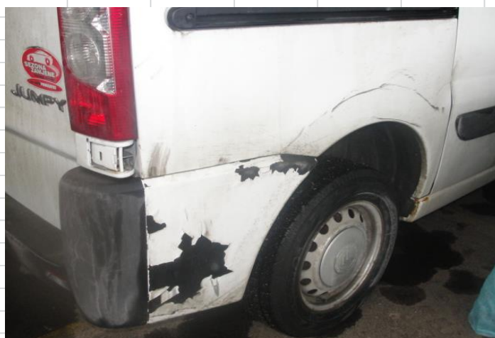
Slika broj 1.5.- oštećenja na limariji otraga desno
